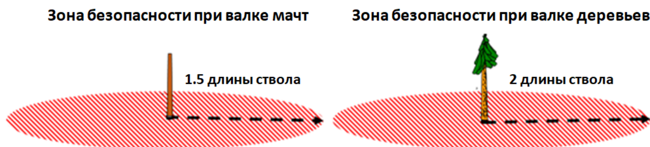
Рис. 4. Опасная зона при валке дерева
