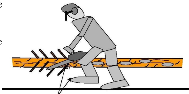
Рис. 44: Неправильное перемещение при обрезке сучьев
