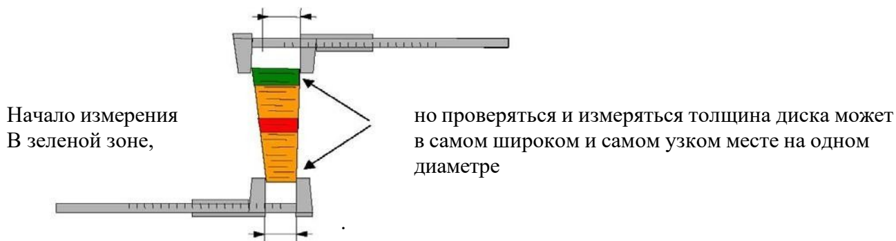
Рис. 30. Измерение толщины диска
