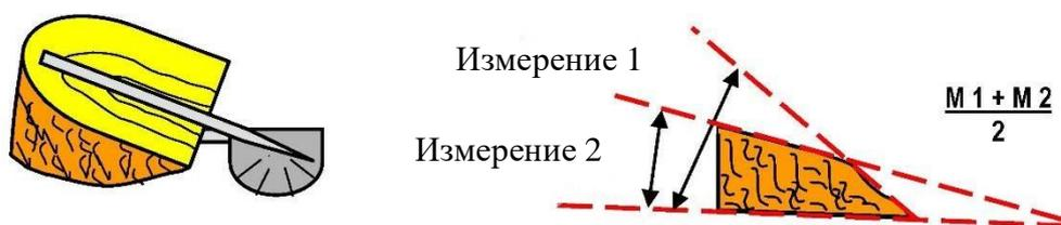
Измерение прямой поверхности реза
