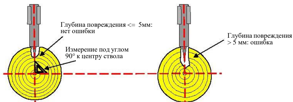
Рис. 41. Измерение слишком глубоких повреждений под углом 90° к центру ствола
